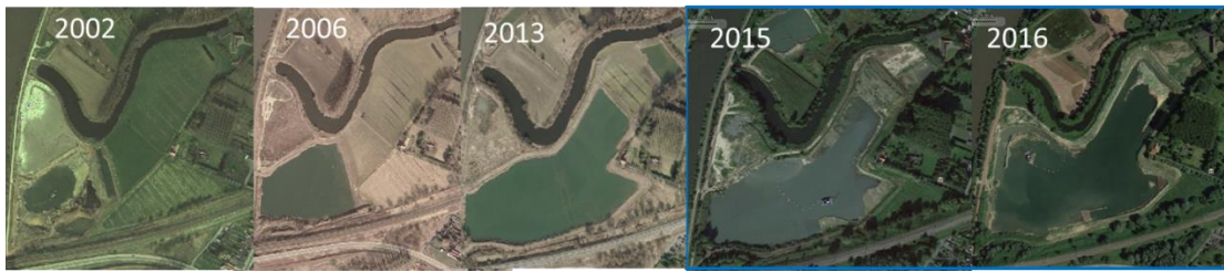
Figuur 10 Tijdreeks van de droge kleiwinning gevolgd door natte zandwinning (vanop de boot) waarbij de grondwaterstand sterk naar beneden werd gebracht met sterke dalingen in de nabije omgeving en mogelijks een beperkt effect tot aan de valleizone van Bos t' Ename op 1.2km.
