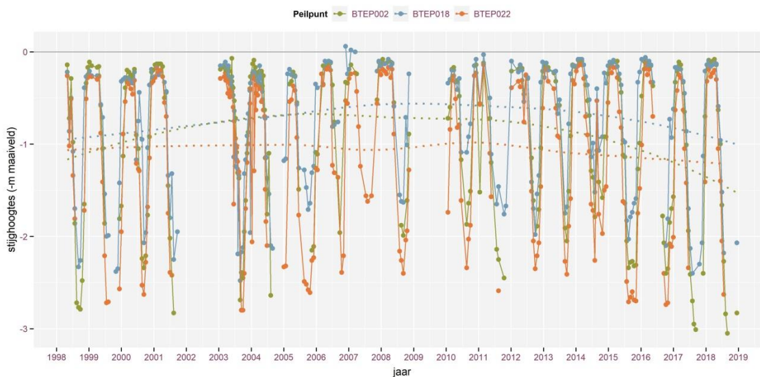
Figuur 8 Temporele evolutie van de grondwaterstanden op de helling met aanduiding van de maandelijkse neerslaghoeveelheden (Oudenaarde, mm blauwe lijn; blauw punt: 1 april) en de evapotranspiratie (Melle, - grijze stippellijn)
